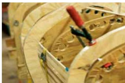
**Zwingend: Die Klemme\* fixiert den Bügel, der Spanngurt die geleimten Leisten.**
