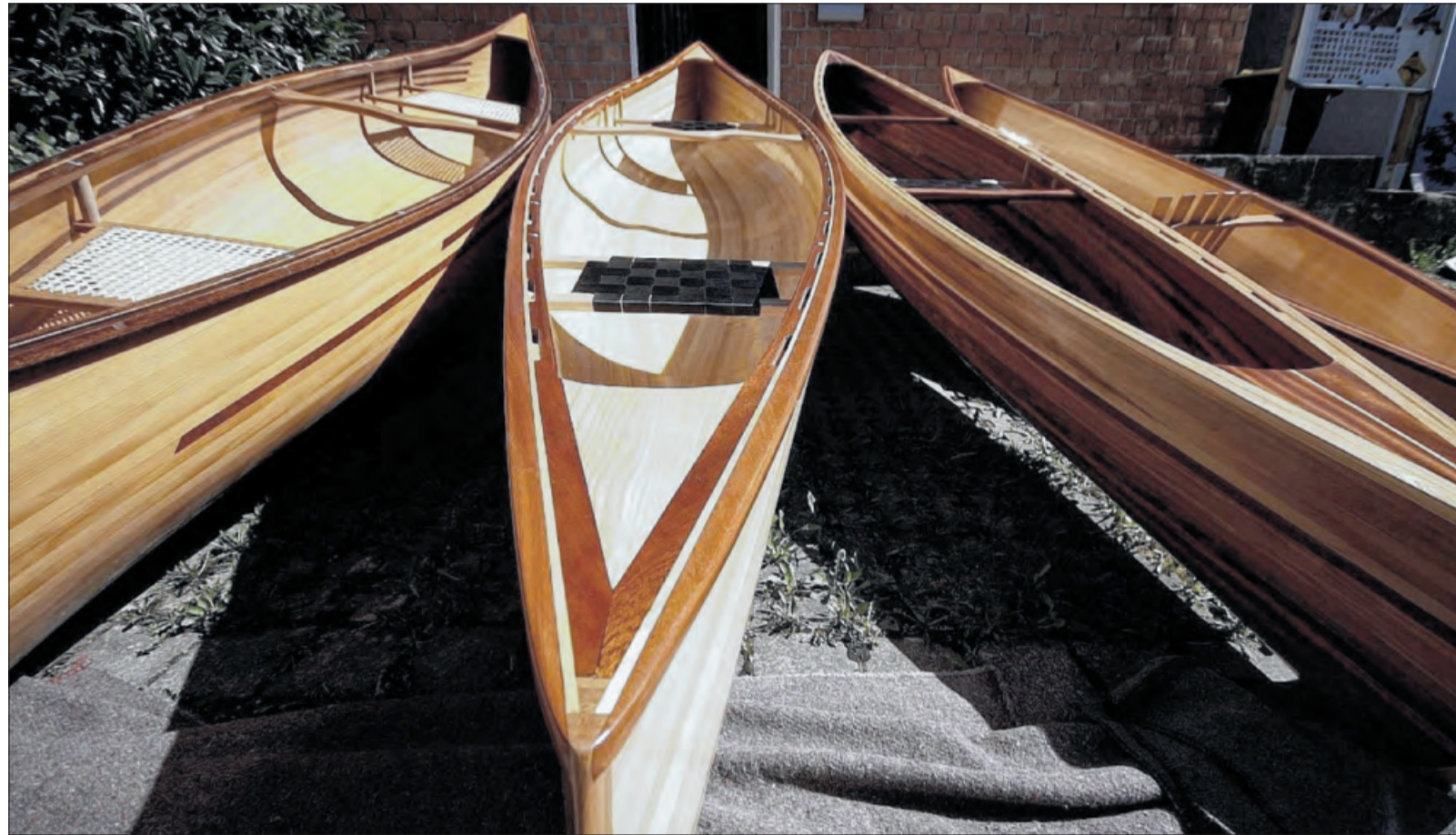
Kanus werden zumeist aus dem Spezialholz Western Red Cedar hergestellt. Doch auch aus Tanne und Fichte werden sie gebaut.
